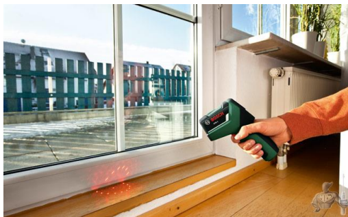
Slika 5 i 6 - infracrveni i sondažni termometri koji se koriste pri energetskim pregledima i betonažama u ekstremnim ljetnim i zimskim uvjetima
