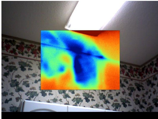
Slika 7 - pronalaženje vlage i plijesni pomocu termografije
