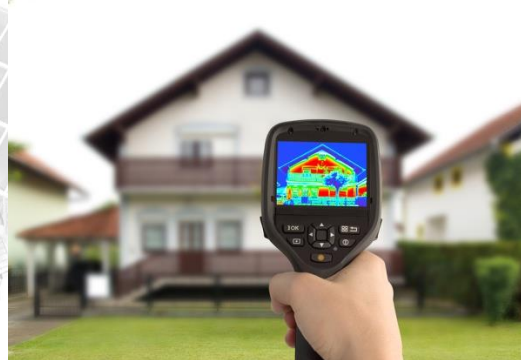
Slika 4 - Energetski pregled termografskom IC kamerom
